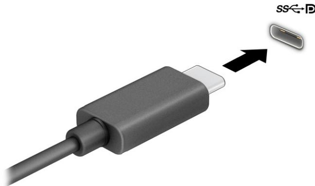
2. Conecte a outra extremidade do cabo ao dispositivo DisplayPort externo.
